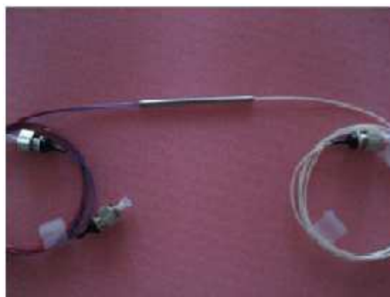
Fibra Ótica emendada por fusão
