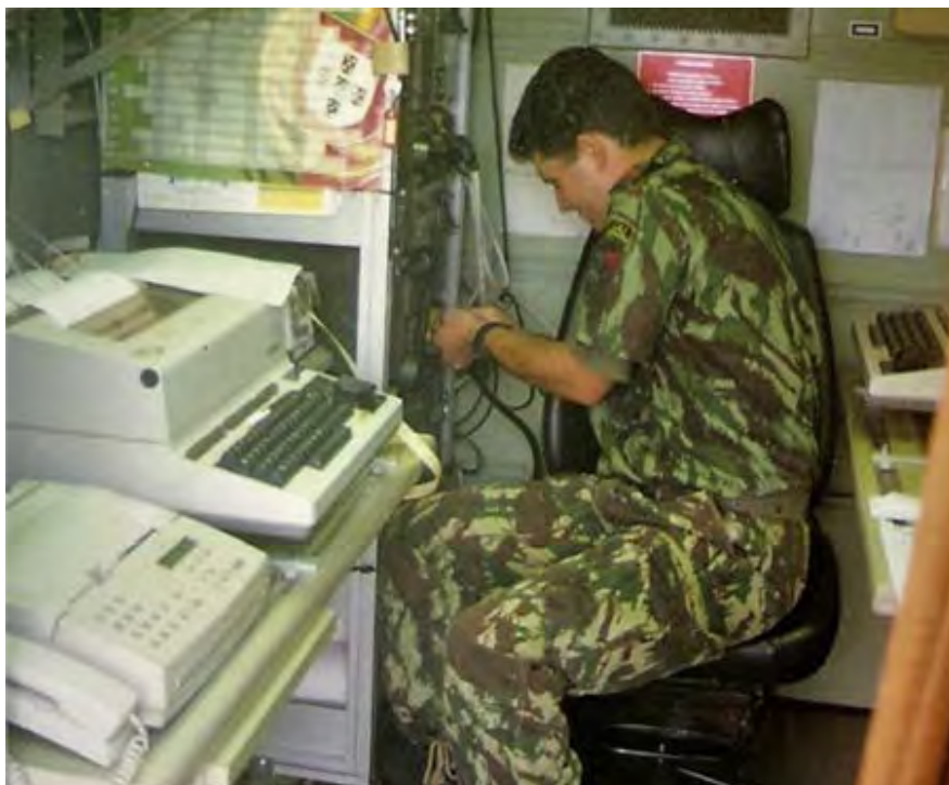
Cabine RATT (Radio Teletype) em viatura tática de 4 Ton. Para a Rede de Comando dos Batalhões. Uma guarnição de um Sargento e três Praças para operar uma estação telegráfica via HF e um terminal satélite, assim como operar a rede fonia HF
