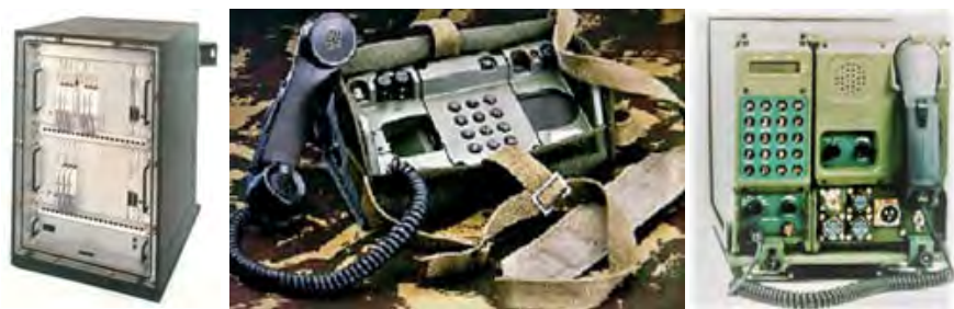
Central telefónica P/TTC-101, (central digital de campanha) e telefone automático P/BLC-101A, ambos de conceção e fabrico nacional. O Emissor Receptor P/VRC-301 resultou de uma joint venture de empresa alemã R&S e portuguesa EID.
